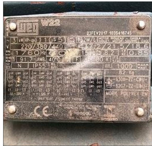
Foto B.6 - Motor (15cv) - Bomba de 90m 3 /h.
