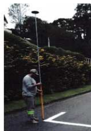
Demarcação de ponto no terreno registrado pelo GPS de alta precisão
